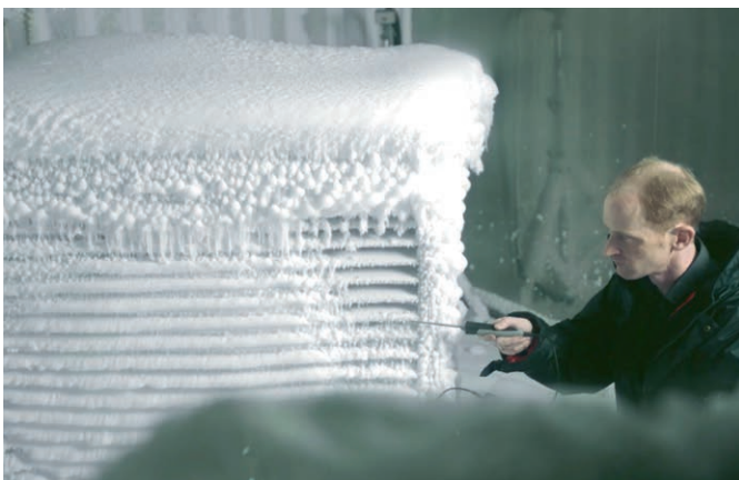
Banco de ensaios testam as unidades em condições climáticas extremas em câmaras de frio.
